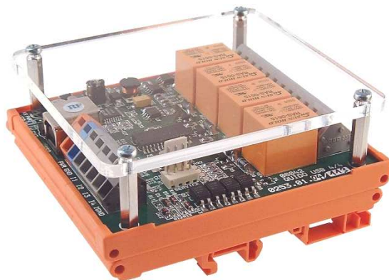
obr. 13 – ukázka provedení s držákem na lištu DIN a s plexi krytem (na obrázku je modul Quido USB 4/4)
